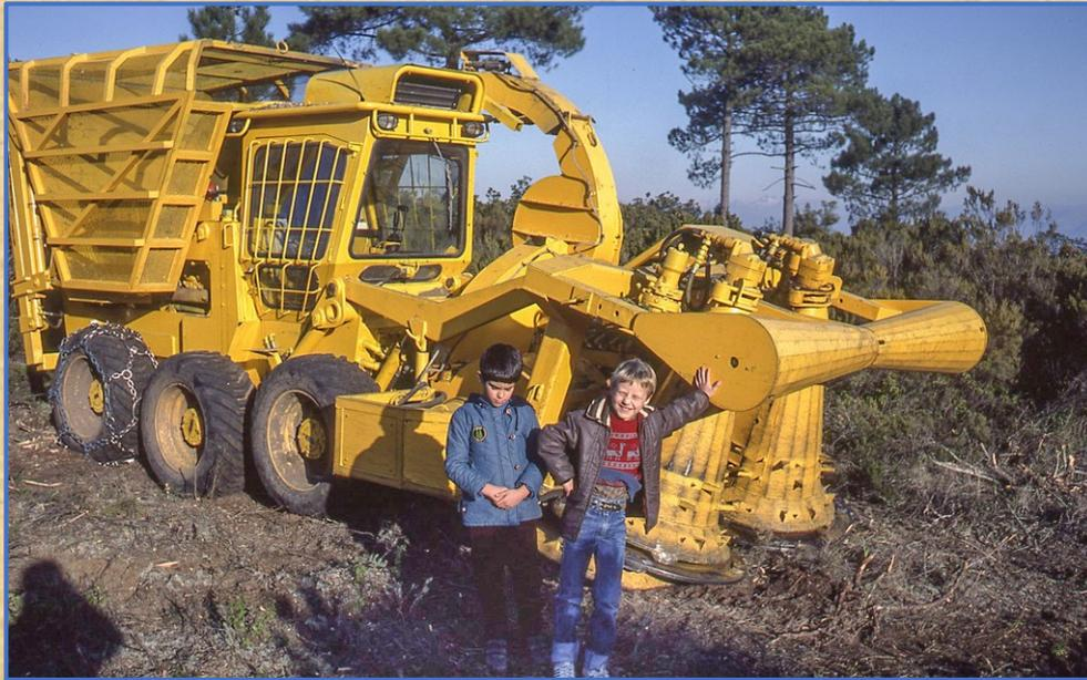
Le prototype SCORPION 2 récolte la totalité de la biomasse épigée des **hauts maquis**, sans dégrader les sols ! Le broyat est soufflé dans une trémie qui peut être bennée dans un camion et transportée directement dans une chaudière adaptée.
